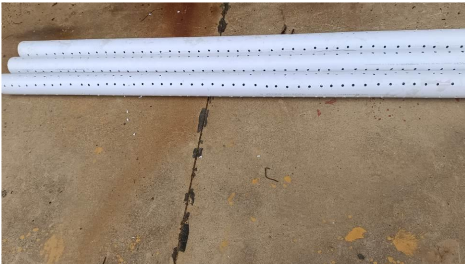
照片 4 打孔排渗管
