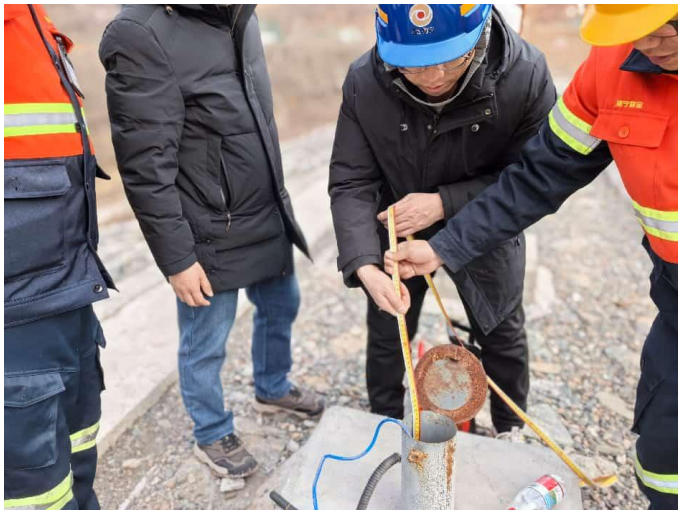
照片 24 现场测量浸润线
