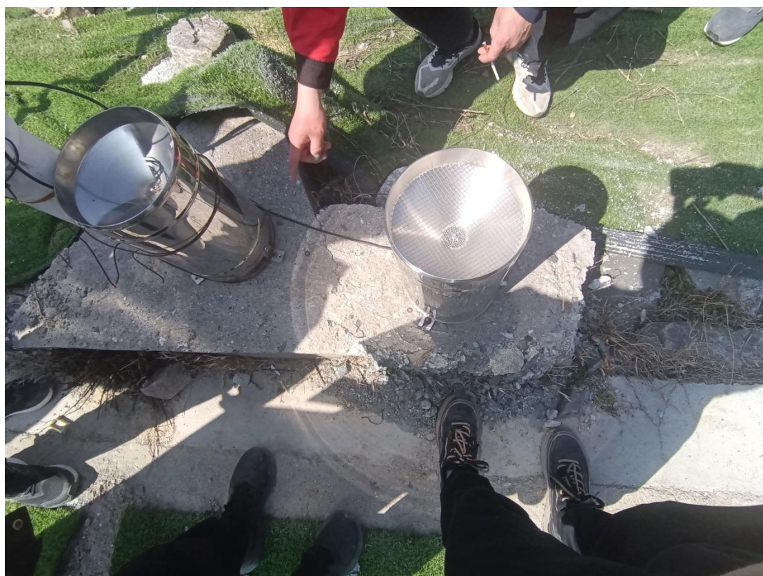
照片十四、初期坝顶雨量计现状照片
