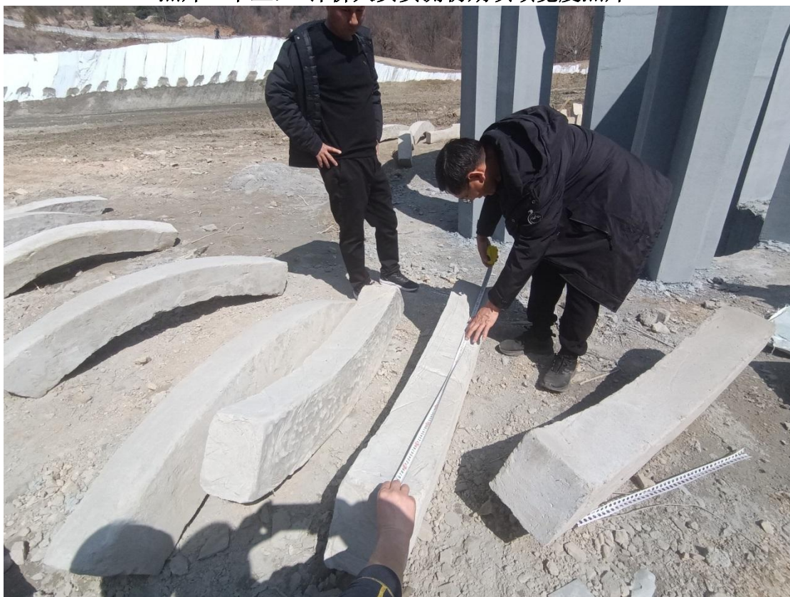
照片二十四： 评价人员实测排水井挡板数据照片
