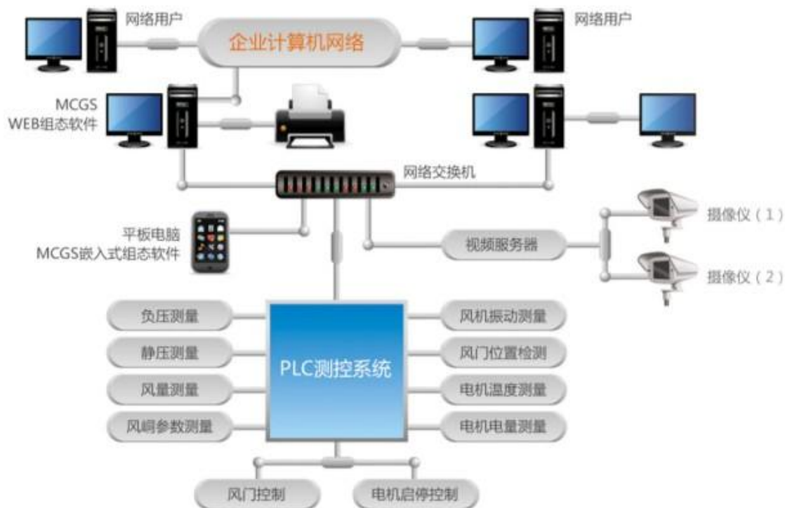
图 2-2 风机在线监测系统架构图
